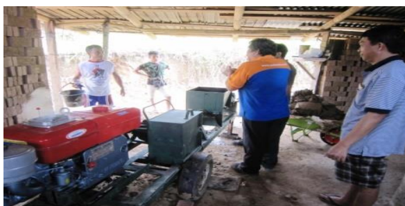
Gambar 6. Uji Coba Mesin Pengaduk dan Pelatihan Penggunaan dan Perawatan Mesin
