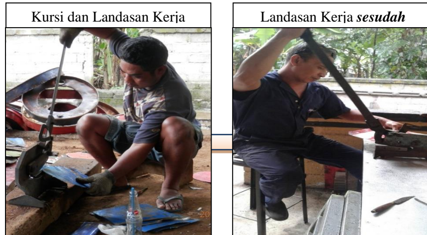
Gambar 3. Perbaikan Landasan Kerja Pemotongan Pelat.
