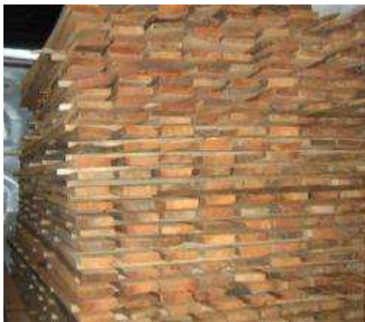
Gambar 3. Teknik Penumpukan kayu kering yang benar
